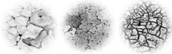
الشكل (5) الصور المجهرية بتكبير 200X للسبيكة 7075 بدون إضافة النيكل بعد تطبيق مختلف المعالجات الحرارية
