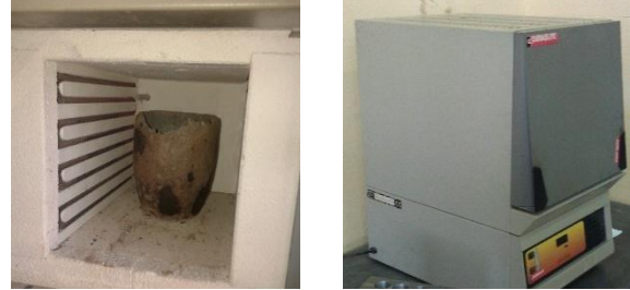
شكل (1) a-الفرن الكهربائي المستخدم في الصهر، b- البوتقة داخل الفرن
