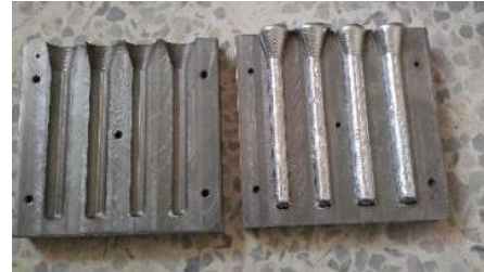
الشكل (2) القالب الفولاذي المستخدم للصب
